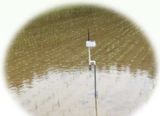
水位センサー (計測データ→スマホに送信)
